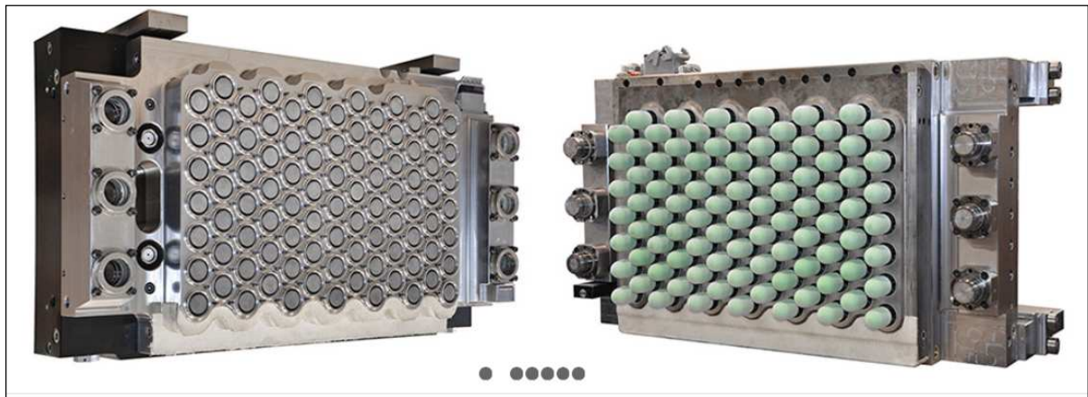
2. ábra Egy hőformázó szerszám két fele. A felső szerszámfél előformázó bélyegeit szintaktikus Hytac habból készítették
