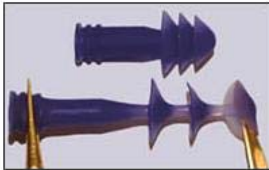
4. ábra A KE2004-20-as típusból fröccsöntött fülldugók jól bírják a szerszámból való kivétel okozta igénybevételt
